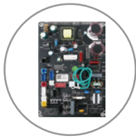
除湿机主板 dehumidifier control mainboard
